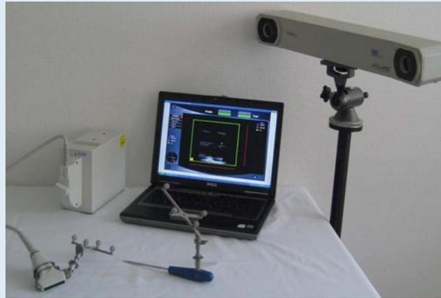
**Abb. 2** ◀ Systemkomponenten der Navigationsnavigation: Ultraschallgerät mit navigiertem Schallkopf (links), navigiertes Zeigeelement (Mitte) und PC mit entsprechend entwickelter Software (Mitte) und Polaris-Koordinatengeber (rechts)
